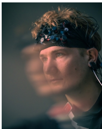
Abbildung 2: Platzierung des funktionelle Nahinfrarotspektroskopie (fNIRS) Systems
