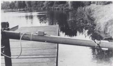
Abb. 2: Das Meßleiner. Rechts unter der Silikonabdeckung befinden sich die Dehnungselemente. Im Gehäuse links sitzt der Verstärker.
