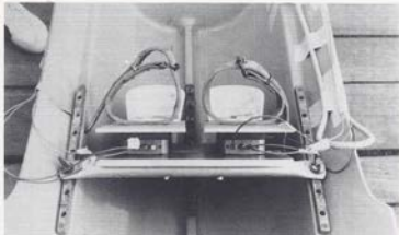
Abb. 1: Das Stembrett. (Es sind nur die Meßelemente unter den Ballen sichtbar.)
